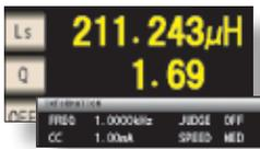
L,Q显示界面(1kHz, CC1mA测量)
