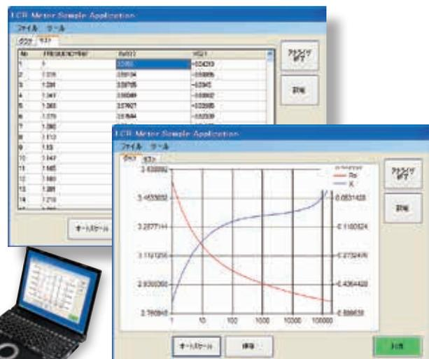
LCR标配软件所显示的扫频测量结果的明细图界面
