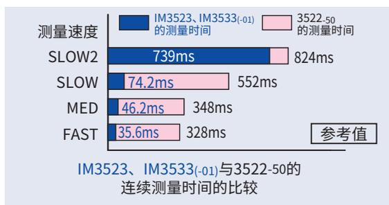
测量电容的C-D和ESR等，会遇到需要改变测量条件并连续测量的情况，与本公司以往机型(3522-50)相比，测量速度全面提高。除各项测量时间的缩短之外，改变量程和频率量程所需要的时间也大幅缩短了。
