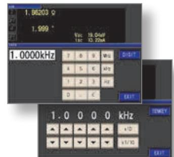
频率的设置(小键盘输入和上下输入)
