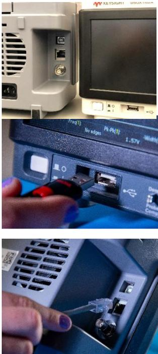
内置 USB 主机端口和 USB 设备端口，可以轻松实现与 PC 的连接。BenchVue 软件结合 BV0004B BenchVue 示波器应用软件 (标配)，让您可以同时控制 1000 X 系列和多项测量，并以可视化方式显示结果。只需使用前面板，即可轻松构建自动化测试序列。简单地点击三下，便可将测量数据导出到 Excel、Word 和 MATLAB，节省许多操作时间。您也可以使用移动设备从任意地方监控您的 1000 X 系列示波器。
