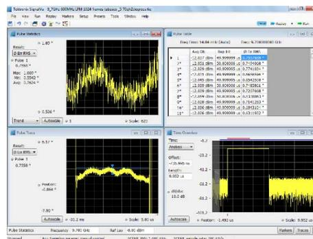
在 70 GHz DPO70000SX 捕获低噪声波形数据之后，可以使用 SignalVu 解调信号，显示星座图和误差矢量幅度 (EVM) 测量及其他所需测量。SignalVu 还作为额外的选项在多个域中提供详细分析功能，如雷达系统工作的脉冲分析和稳定时间，新兴调制标准的数字调制分析和通用 OFDM 分析，以及更宽带宽要求的 AM/FM/PM 调制和音频测量。
