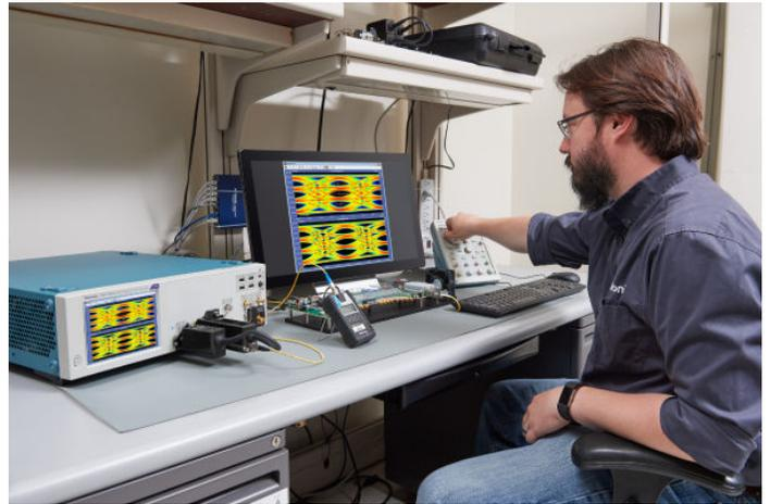
在使用 400 G 网络的情况下，每通道的串行数据传输速度现在可达 56 Gb/s，这导致 NRZ 信号技术不太实用。目前，广泛将高带宽效率 PAM4（4 级脉冲幅度调制）信号用于达到此新性能水平。通过使用 DPO70000SX 系列及其行业领先的低噪声 ATI 技术，可以最有效地进行准确的 PAM4 验证，在测量结果中实现最佳的有效位性能。为进行 PAM4 分析，DPO70000SX 选件 PAMJET-E 和 PAMJET-O 结合了行业先进的均衡工具和基于稳定的内置软件的时钟恢复功能。这对于恢复复杂时序和执行高速 ISI PAM4 信号至关重要。
