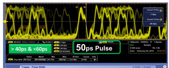
DPO70000SX 包括独特的包络触发模式，可以直接触发被调制载波的包络。对检测到的包络可以应用边沿触发、宽度触发和超时触发等触发类型，稳定触发被调制的突发或区分特定宽度的突发。载频可以在 500 MHz ~ 20 GHz 之间，适应各种应用。下图显示触发特定宽度的突发。
