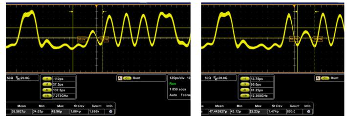
下图中使用脉宽区分功能，隔离宽度 >40 ps 和 <60 ps 的脉冲，显示可靠地捕获 20 Gbps PRBS11 序列内 50 ps 脉冲。
