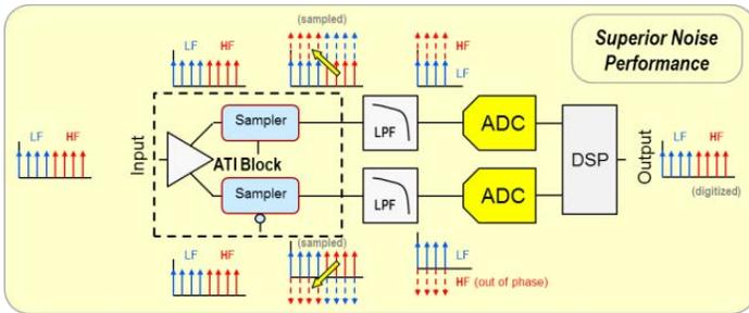
通过数字化两份完整的信号能量，信号频谱使用相当于采样过程的 DSP“展开”，然后组合起来，复现输入信号。由于两份信号组合在一起，该流程有效平均这些信号，降低了随机噪声。采样流程引入的相位倒置会导致中频成分直接相互抵消，简化重建和校准。
