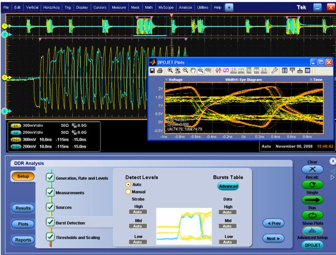
**DDR 内存总线分析 (选项 DDRA、DDR-LP4)** - 自动识别 DDR1、LPDDR1、LPDDR2、LPDDR3、DDR2、DDR3、DDR4、LPDDR4/LPDDR4X 和 GDDR3 读和写, 并进行 JEDEC 符合性测量, 为每个读写突发脉冲的所有边沿提供通过不通过结果。DDRA 具有对时钟、地址和控制信号进行测量的能力。除了可以进行一致性测试之外, DDRA 与 DPOJET 相结合, 还为调试复杂的内存信号问题提供了最快速的方式。DDRA 在提供 16 条数字逻辑探测通道的 MSO70000DX 系列混合信号示波器上运行时, 还可以使用命令地址行触发特定读写状态。
