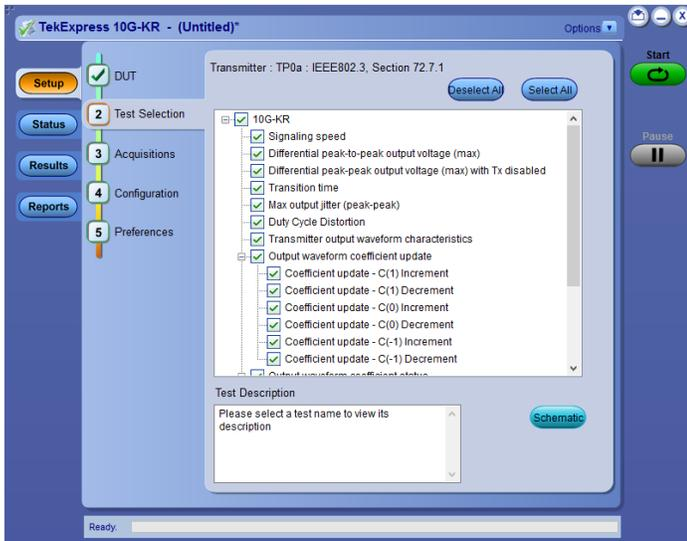
**10GBASE-KR/KR4 一致性测试和调试解决方案 (10G-KR 选项)** - 根据 IEEE 802.3ap-2007 规范自动进行一致性测量。此选项包括一个自动化一致性解决方案，以及使用 DPOJET 进行调试的功能。自动化测试设置测量发射机均衡电平，每次点击时生成 12 个结果，并为 9 种不同测量生成 120 个结果，用时大约 15 分钟。
