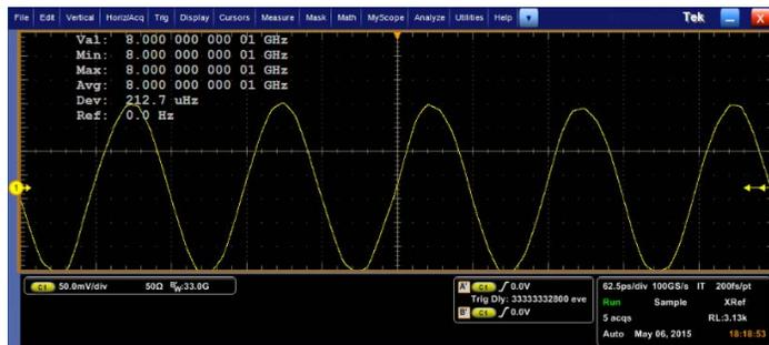
这种功能可以进行高度准确的时钟稳定性测量。在所示的屏幕截图中，我们在 8 GHz 精密源上测得 212  $\mu$ Hz 的源漂移偏差。在该图中，信号发生器设置为 8.0000000001 GHz，示波器精确测量到这一数值。
