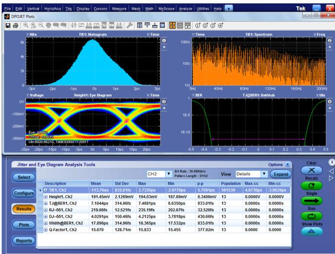
DPOJET 抖动和眼图分析 - 简化识别信号完整性问题、抖动和相关来源的过程。
