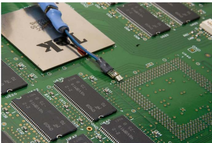
P7500 三模探头使用低成本的焊接式探测尖端，可以迅速连接，这样在多个焊接点之间移动探头可以变得快速而简便。
