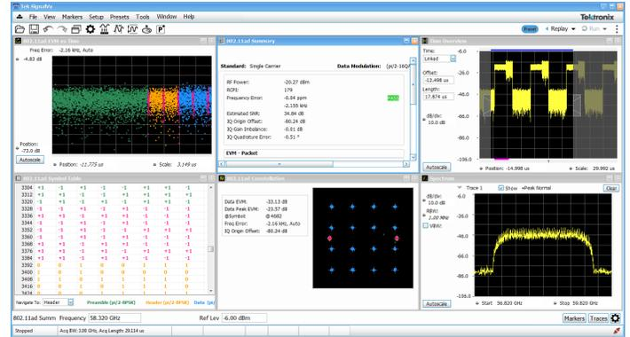
DPO77002SX 及 SV30 提供了业内最佳的 EVM 精度。设置简便，可以执行各种发射机测量，包括突发脉冲的时间概述、频谱、星座图、解码突发脉冲信息和 EVM 测量。
