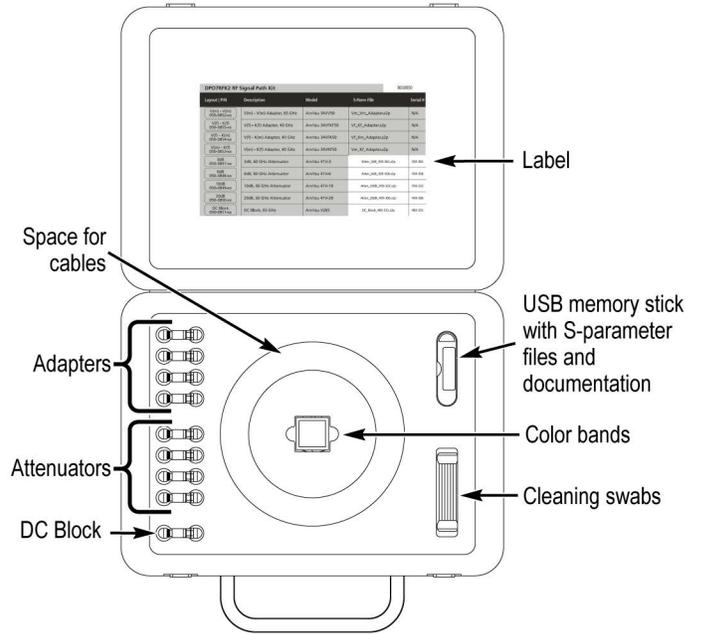
检定 DPO7RFK2-Extended 1.85 mm 的衰减器适配器套件。
