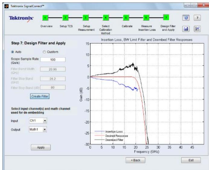
SignalCorrect 创建一个滤波器，您可以对自己的示波器输入应用此滤波器，以反嵌被测器件或互连。
