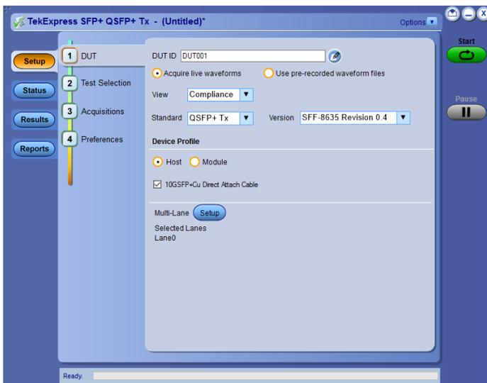
**TekExpress SFP+ QSFP+ Tx (选项 SFP-TX、SFP-WDP)** - TekExpress SFP+ QSFP+ Tx 是在实时示波器平台上开发的，该平台是工程师们围绕 SFF-8431 和 SFF-8634 技术来设计产品时的首选平台。SFP-TX 和 SFP-WDP 选项支持自动化解决方案 (用于一致性) 和 DPOJET 选项 (用于调试)，与手动测试相比，用户可以节省高达 80% 的测试时间。TWDPc - SFP-WDP 选项提供铜测量发射机波形失真罚值。基于 SFF-8431 SFP+ TWDPc 的 Matlab 代码集成到 SFP-WDP 选项中，确保工程师能够在自动设置中使用这一测量方法。
