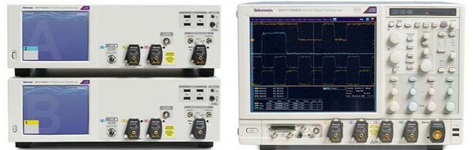
DPO73304SX 示波器提供了两条 33 GHz、100 GS/s 采集性能的通道或四条 23 GHz、50 GS/s 实时采集性能的通道。这种型号提供的采集性能与 DPO73304DX 台式型号类似，但采用全新的紧凑型仪器外形。
