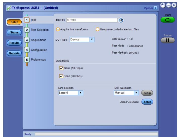
TekExpress® USB4 自动化测试软件 (选件 USB4) - TekExpress® USB4 合规性和调试解决方案提供了一种简单的方法，可根据 USB4 电气合规性测试规范 (CTS) 来验证和表征最新的 USB4 路由器-主机、USB4 路由器-设备和 USB4 集线器。泰克 MSO/DPO70000DX 和 DPO70000SX 系列示波器 (带宽 ≥ 23 GHz) 支持泰克 USB4 合规性和调试解决方案。
