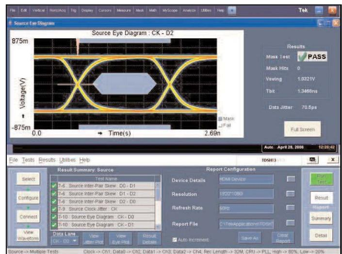
**HDMI 合规性测试解决方案 (选项 HT3)** - 不管您是正在开发源型、电缆型还是漏型解决方案，它都能为您提供一种应对 HDMI 合规性测量挑战的快速、有效的解决方案。此应用程序提供了帮助您确保测试质量和操作性的所有 HDMI 合规性测试解决方案。
