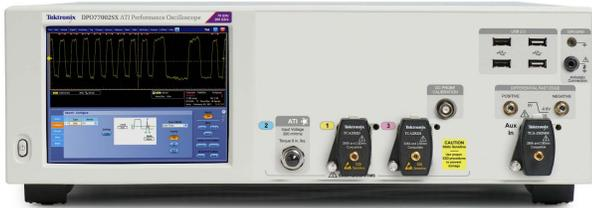
DPO70000SX 提供了高达 70 GHz 模拟带宽的超高带宽实时信号采集和分析功能。荣获专利的异步时间交织 (ATI) 架构为实时信号采集提供低噪声和高保真度。
