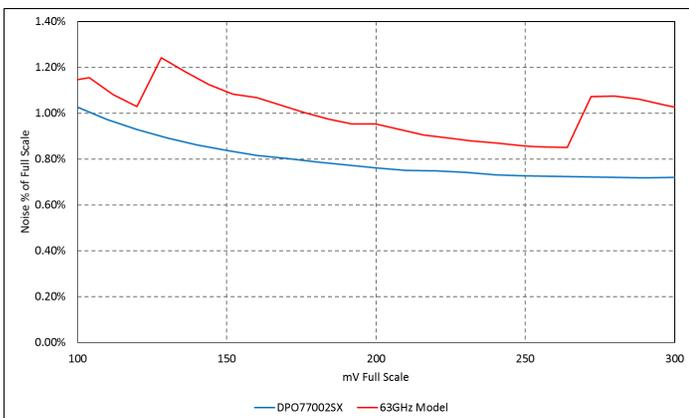
DPO77002SX 与其他厂商的 63 GHz 型号比较：FS 的基本噪声百分比与 mV<sub>FS</sub> 设置，轨迹居中，60 GHz 带宽，最大采样率设置 (200 GS/s 或 160 GS/s)
