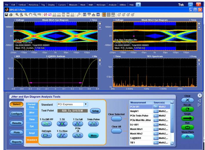
PCI Express® 发射机合规性和调试 (选件 PCE3、PCE4、PCE5、PCE6) – 通过全面的测试支持，分析 PCI Express® Rev 1.0、2.0、3.0、4.0、5.0 或 6.0 设计质量。使用 DPOJET 和 PAMJET 选件 PCE3、PCE4、PCE5 及 PCE6，可执行符合 PCI-SIG 标准的测试。
