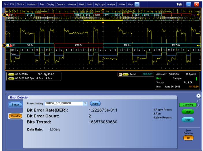
误码检测器 (BITERR 选项) - 对位数和检测到的错误数提供统计信息, 并在检测到误码时显示波形数据。如此处所示, 误码检测器可以与可选的串行数据解码器结合使用, 以便调试和诊断错误。
