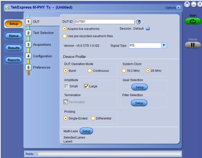
**TekExpress M-PHY Tx (选项MPHY40、MPHY50)** - TekExpress M-PHY Tx 根据 Spec 5.0 提供 100% 的测试支持。这一解决方案是为根据 CTS 进行检验和验证的工程师设计的，适用于 MPHY50 的高速 (HS)-Gear1、Gear2、Gear3、Gear4 和 Gear5，以及 MPHY40 的 HS-Gear1、Gear2、Gear3 和 Gear4。它还支持选项 MPHY50 和选项 MPHY40 产品中的 UFS4.0 参考时钟测量。
