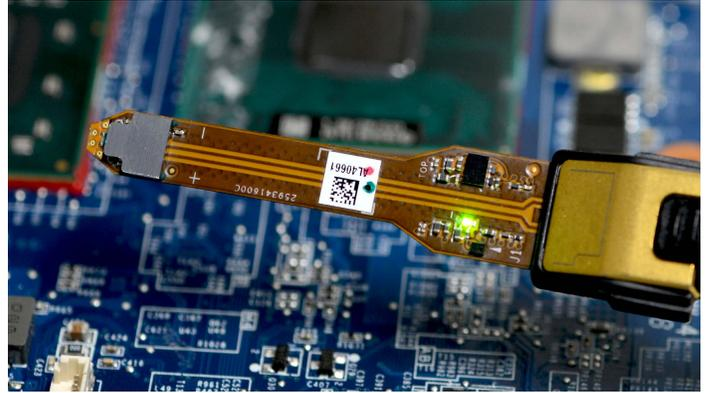
P77STFLXA 焊接柔性电路附件在尖端上有一个有源缓冲放大器，提供了高达 20 GHz 的带宽。
