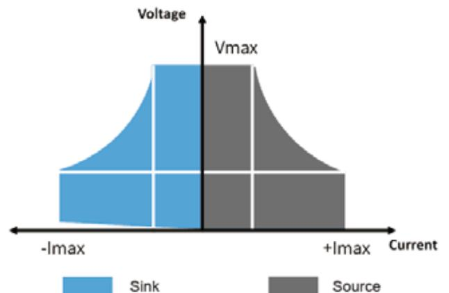
IT-M3900B系列作为回馈双向直流电源使用时可以实现高速的源和载电流模式转换，从而在输出和吸收电流之间进行快速连续的无缝切换，有效避免电压或电流过冲，广泛适用于电池、电池封装以及电池保护板等储能设备测试。
