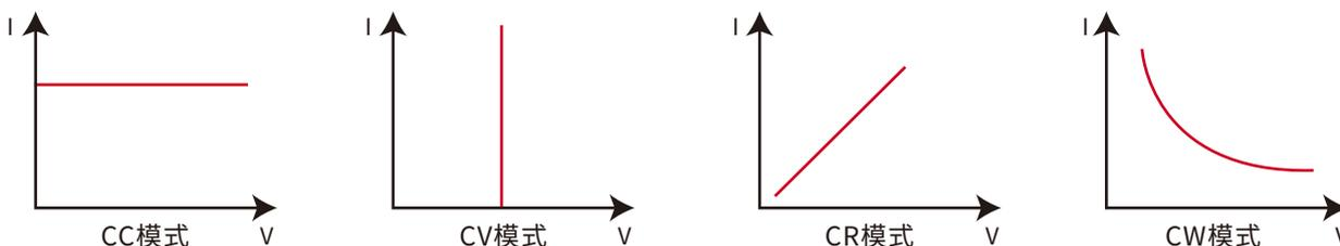
IT-M3900B在负载功能下还具备CC+CR、CV+CR、CV+CC和CC+CV+CW+CR等4种复合式操作模式,可适应于多种场合的测试需求。
