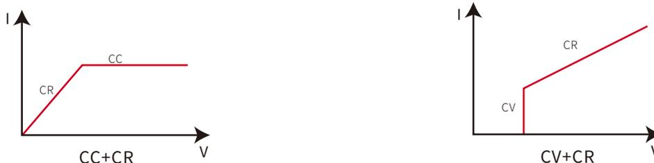
CC+CR模式常用于车载充电机限压、限流特性测试、恒压精度、恒流精度的测试中,防止车载充电机的过流保护。
