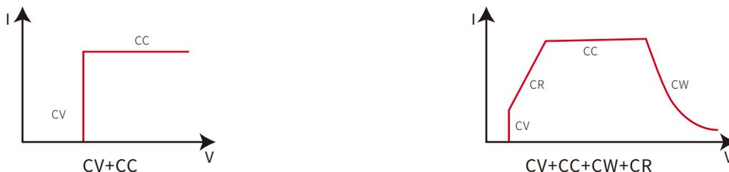
CV+CC模式可以应用于负载模拟电池,测试充电桩或车载充电器的场合,CV工作的同时,限制拉载最大电流。
